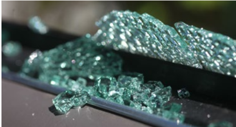
Abb. 4 Schollenbildung nach ESG-Bruch
