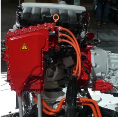
Bild 5: Basisschutz durch Isolation und Abdeckung
